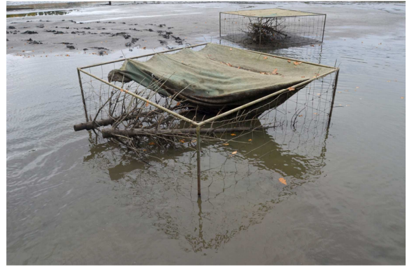
Abbildung 21: Vor allem die Kabelbinder zum Befestigen der Abdeckplanen halten der hohen Belastung offenbar nicht stand.
