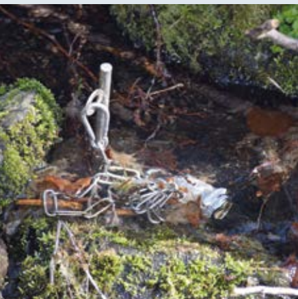
Ein Logger misst fortwährend die Temperatur.
