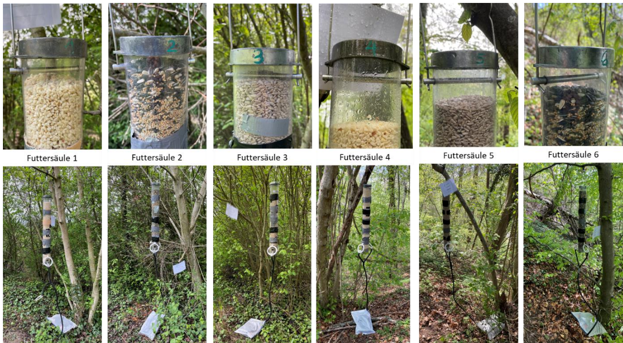
Abbildung 10: Aufbau der Futtersäulen mit den drei verschiedenen Futtermittelformen und den montierten RFID-Antennen.
