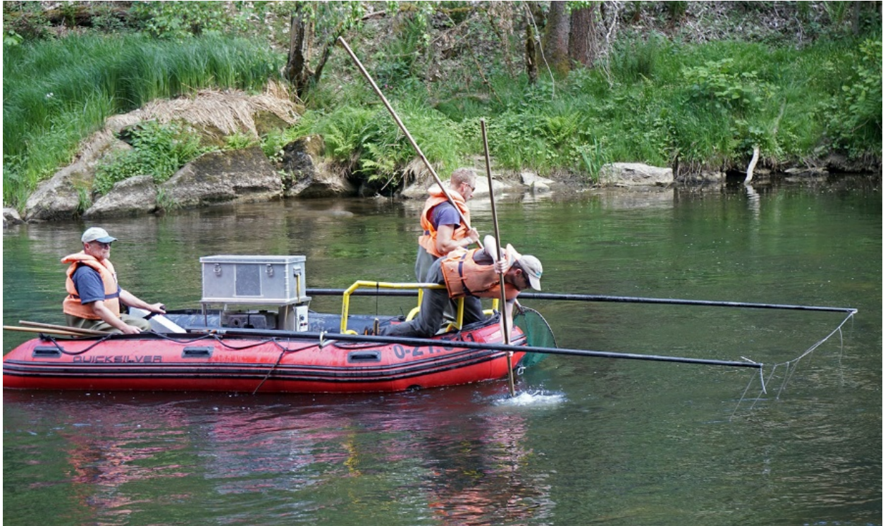
Abbildung 8: Am Schwarzen Regen eingesetztes Elektrofangboot mit Anodenrechen.
