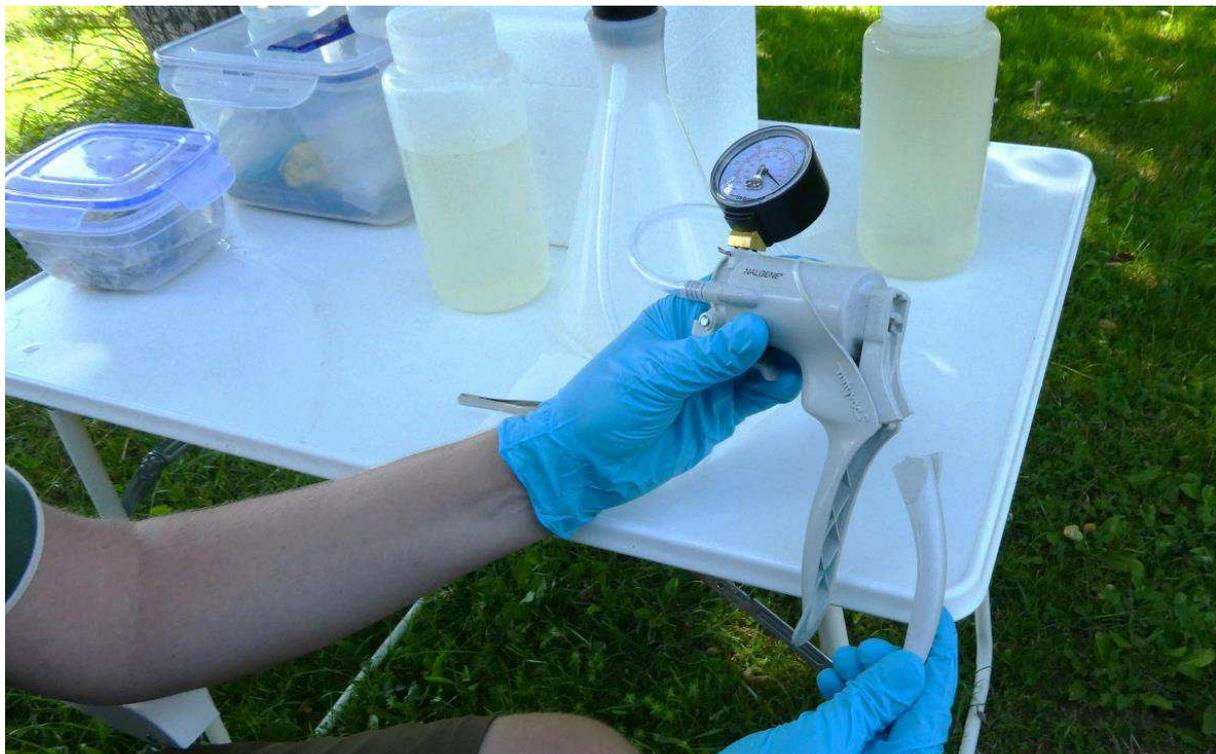
**ABBILDUNG 2:** Bereits bei der dritten Probestelle erlag die PVC Handpumpe einer Ermüddungserscheinung und musste getauscht werden. Es empfiehlt sich, stets Ersatz parat zu haben.
