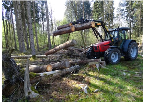
⤴ *Bergung von Käferholz mit einer Seilwinde (links) und Wiederausbringung zur Totholzanzreicherung nach Austrocknung. Es sollten möglichst wenige Bereiche des Waldbodens befahren werden, beispielsweise durch Beschränkung auf vorhandene Rückegassen und Wege. Alternativ könnte ein Rückepferd eingesetzt werden (siehe dazu die Handlungsempfehlung Waldnaturschutz: Einsatz von Rückepferden aus dieser Reihe).*
